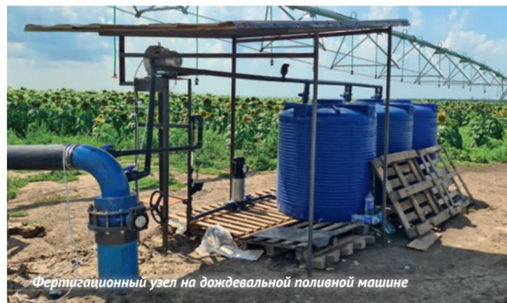
Фертигационный узел на дождевальной поливной машине
