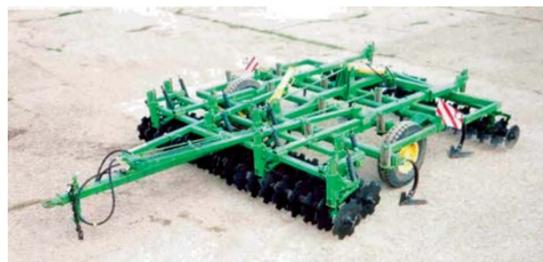
Это позволило в 2 - 4 раза увеличить ресурс ножей. Плуги-рыхлители ПБ обладают высокой надежностью, работают на скорости до 12 км/ч. Они хорошо зарекомендовали себя в засушливых зонах, т.к. при глубине обработки до 35 см позволяют хорошо накапливать и сохранять влагу в почве.
