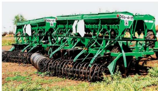
шиностроительный завод), уникальна тем, что каждый ее вырезной диск расположен на собственной стойке и оси, что расширяет возможности регулировки угла атаки и рабочей ширины захвата, ускоряет ремонт. При этом также улучшается качество разделки почвы, ее можно вести во влажную погоду, при любом количестве растительных остатков и с меньшей кратностью проходов по полю. Глубина обработки – 6 - 15 см, ее можно вести на скорости до 25 км/ч!
