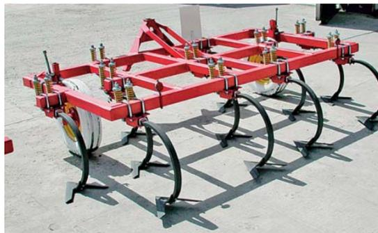
и машиностроения» (Белгородская область), которые также позволяют работать на тяжелых, заливших, глыбистых и сухих почвах. Эти орудия по характеру работы напоминают знаменитые германские культиваторы «Смарагд», да и по качеству исполнения полностью соответствуют техническим условиям. При изготовлении рабочих органов этих орудий используют износостойкие стали, которые до недавнего времени применялись только в «оборонке». Эти рабочие органы почти не изнашиваются!
